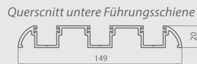
Querschnitt untere Führungsschiene
